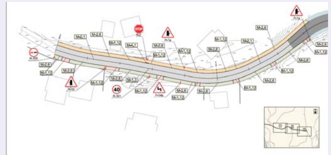
Planta de señalización.
